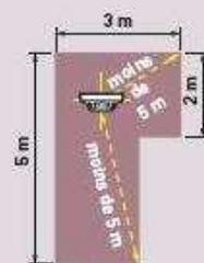
Couloir à surveiller,  $12\text{ m}^2$ , pas de zones à surveiller à plus de  $5\text{ m}$  d'un détecteur, donc 1 détecteur.
