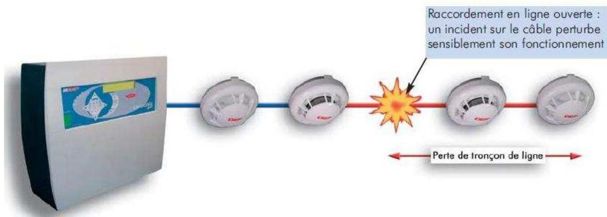
Avec une ligne rebouclée, un défaut est relevé et signalé mais l'ensemble fonctionne correctement car il est alimenté des deux côtés de la boucle.
