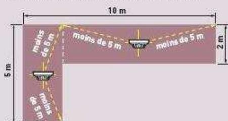
Couloir à surveiller,  $26\text{ m}^2$ , mais des zones à surveiller à plus de  $5\text{ m}$  d'un détecteur, donc 2 détecteurs.
